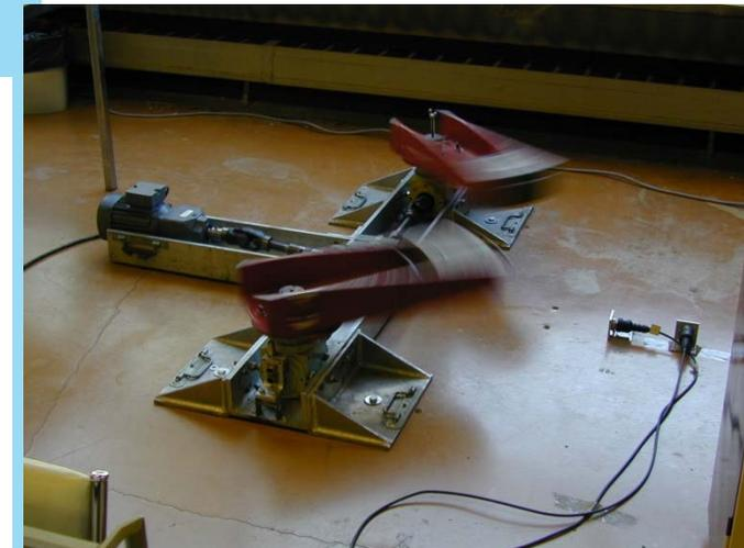
*Excitateur à balourds contrarotatifs : dispositif d'excitation harmonique permettant de générer une force unidirectionnelle contrôlée en fréquence entre 0.1 Hz et 7 Hz.*
