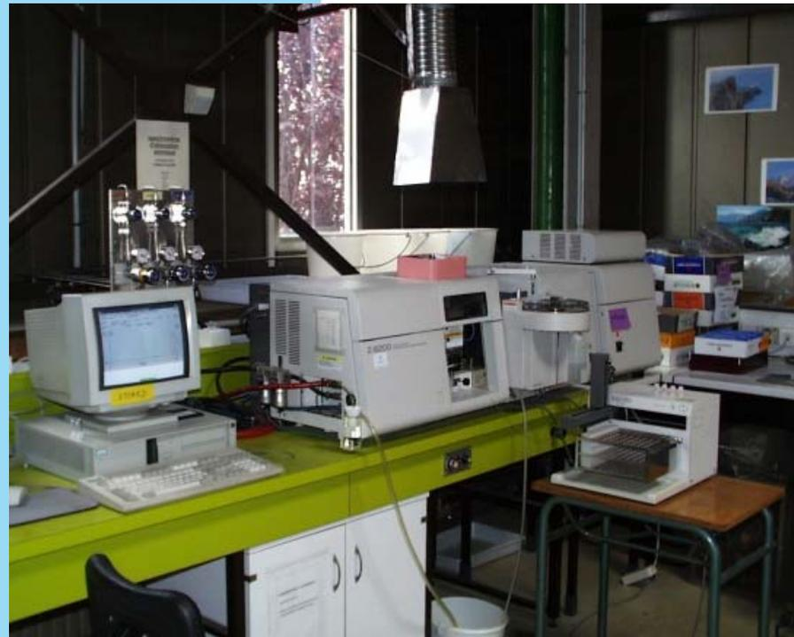
*Spectrophotomètre d'absorption atomique : analyse de métaux lourds dans les percolâts*
