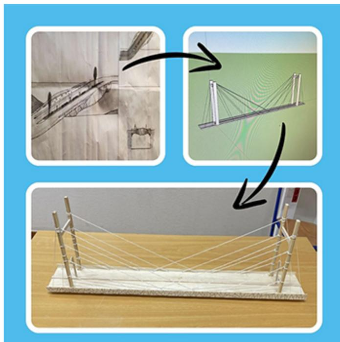
*Après avoir réalisé des esquisses et modélisé leurs idées, les élèves ont construit des maquettes de leurs ponts en bois de balsa et de sapin.*
