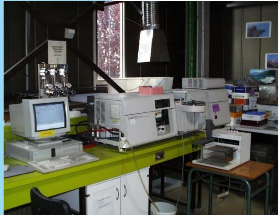
*Spectrophotomètre d'absorption atomique : analyse de métaux lourds dans les percolâts*
